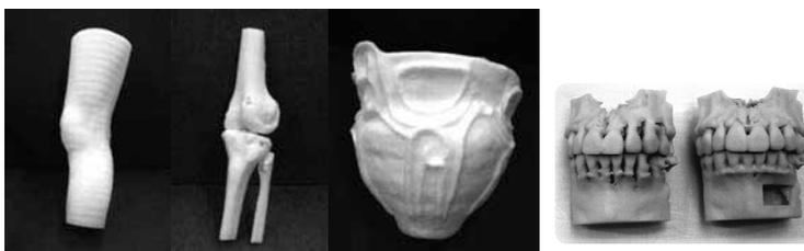
図1 3Dプリンタによる実物モデルの生成例
